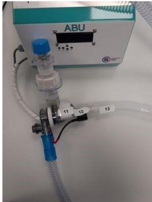
*Figura 12: Conexión de los sensores al tubo de aire.*
