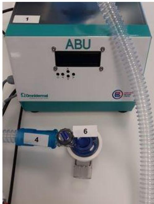
*Figura 8: Conexión de la válvula de control con el tubo de aire estándar.*
