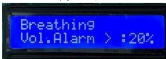
Figura 35: Pantalla de selección de la pérdida tolerable para la activación de la alarma audible.
