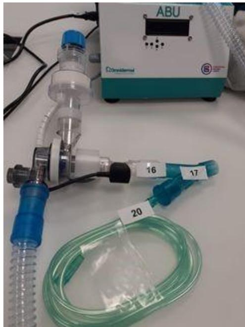
*Figura 22: Conexión del tubo de oxígeno.*
