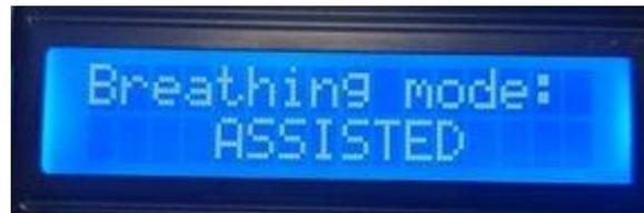
Figura 30: Pantalla de confirmación del modo de ventilación seleccionado.
