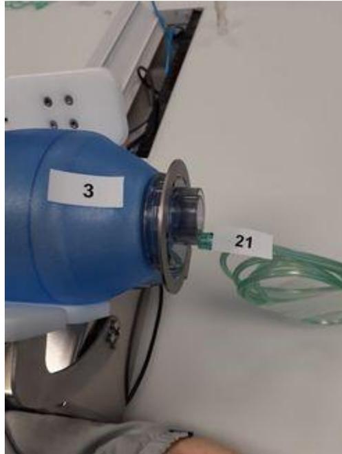
*Figura 15: Conexión del tubo de oxígeno al balón AMBU.*
