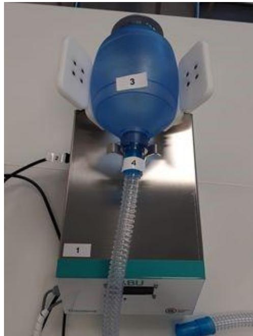
*Figura 6: Conexión del tubo de aire.*
