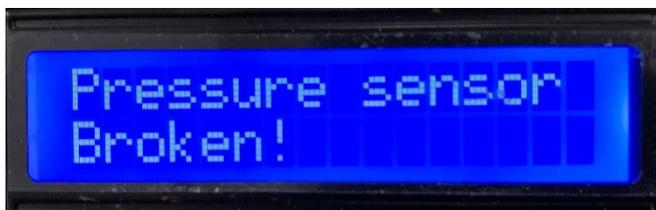
Figura 49: Pantalla de alarma de mal funcionamiento del manómetro
