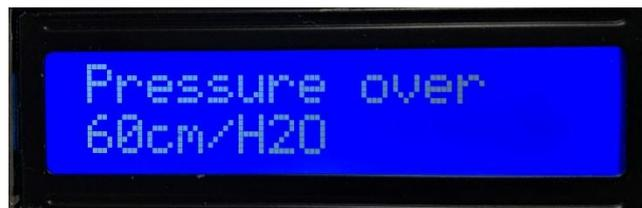
Figura 47: Pantalla de alarma de presión elevada, superior a 60 cm H<sub>2</sub>O.
