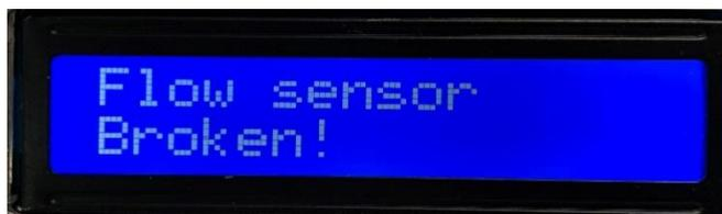
Figura 48: Pantalla de alarma de mal funcionamiento del sensor de flujo.
