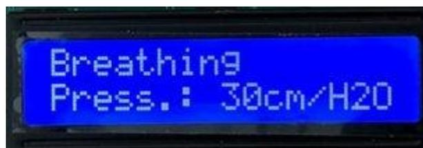
Figura 33: Pantalla de selección el valor de la presión máxima permitida, en cm de H<sub>2</sub>O.
