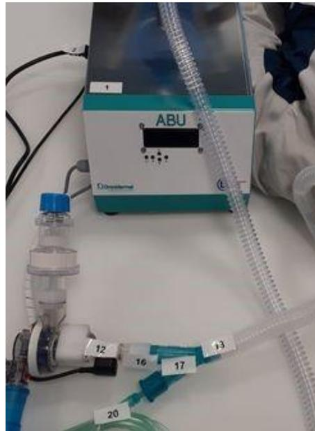
*Figura 23: Conexión del tubo de aire ajustable al conector en Y ensamblado.*
