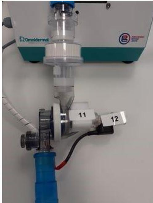
*Figura 11: Conexión del sensor de presión y del flujómetro.*
