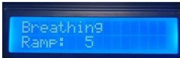
Figura 40: Pantalla de selección del parámetro de tasa de incremento de la presión de soporte (Ramp).
