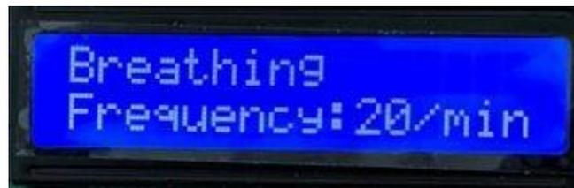
Figura 31: Pantalla de ajuste de la frecuencia respiratoria.
