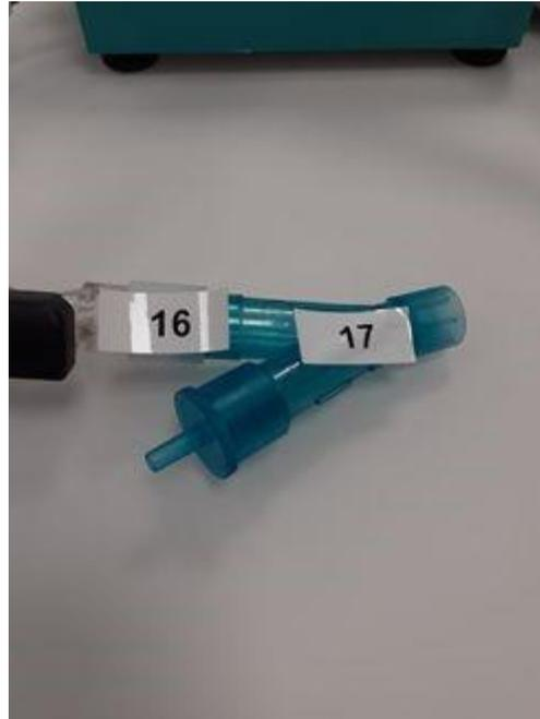
*Figura 21: Conexión del conector en Y a los sensores.*
