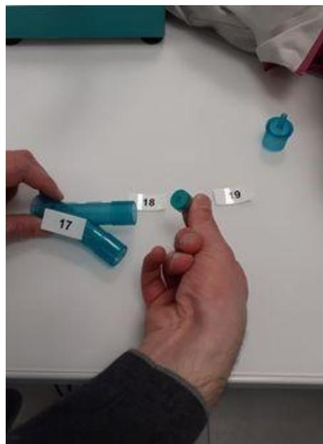
*Figura 18: Inserción de la válvula unidireccional.*
